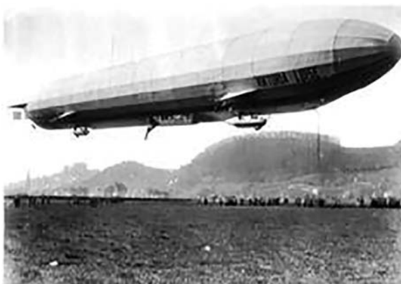
Fig. 31 - Il dirigibile Zeppelin LZ 11 “Victoria Luise” che fra il 1912 e il 1914 trasportò 9.783 passeggeri in 489 voli, coprendo 54.312 km.
